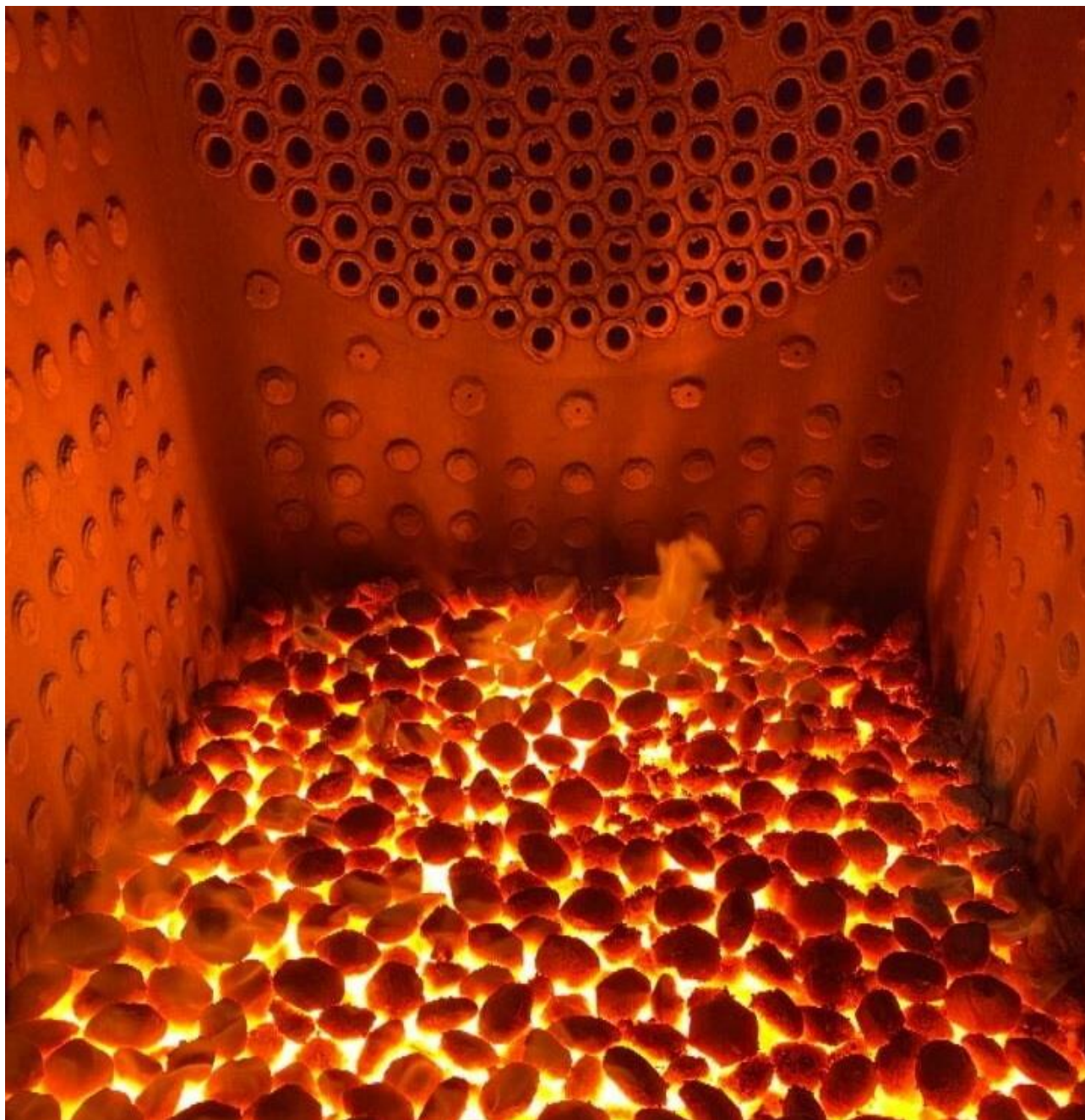
Vista del focolare con i pezzi Ecoal incandescenti. Probabilmente è la prima volta che una locomotiva a vapore svizzera viene alimentata con biocombustibile.
