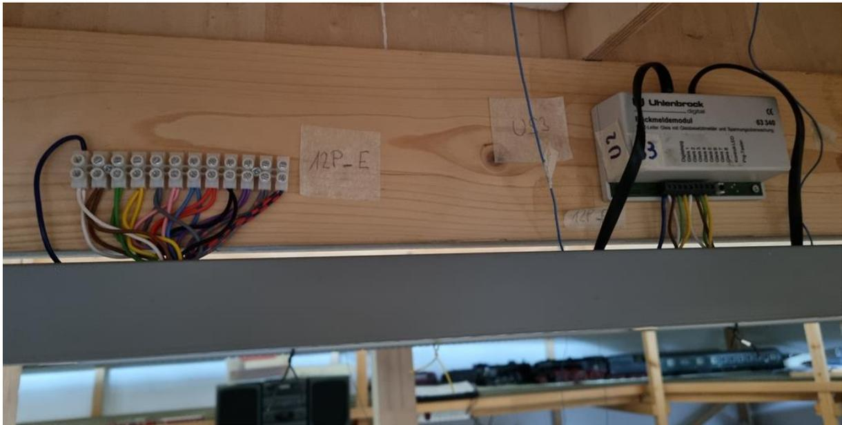
Il canale grigio serve a contenere i vari cavi. Sopra il canale, a sinistra, si vede la morsetteria del cavo bus 12 poli, a destra un decoder Uhlenbrock dedicato all'alimentazione di 8 segmenti di linea. Le etichette definitive non sono ancora state stampate.
