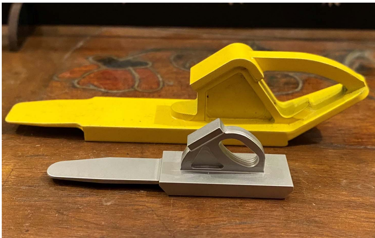
Le scarpe in due scale, davanti dopo la sabbiatura, dietro dopo la termolaccatura
