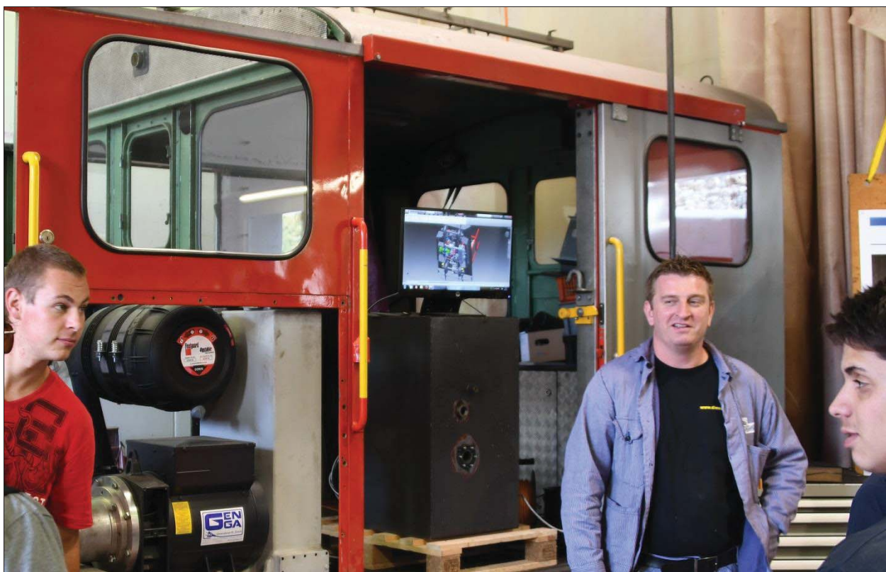
Rifacimento della motorizzazione della locomotiva diesel a cremagliera HGm 51
