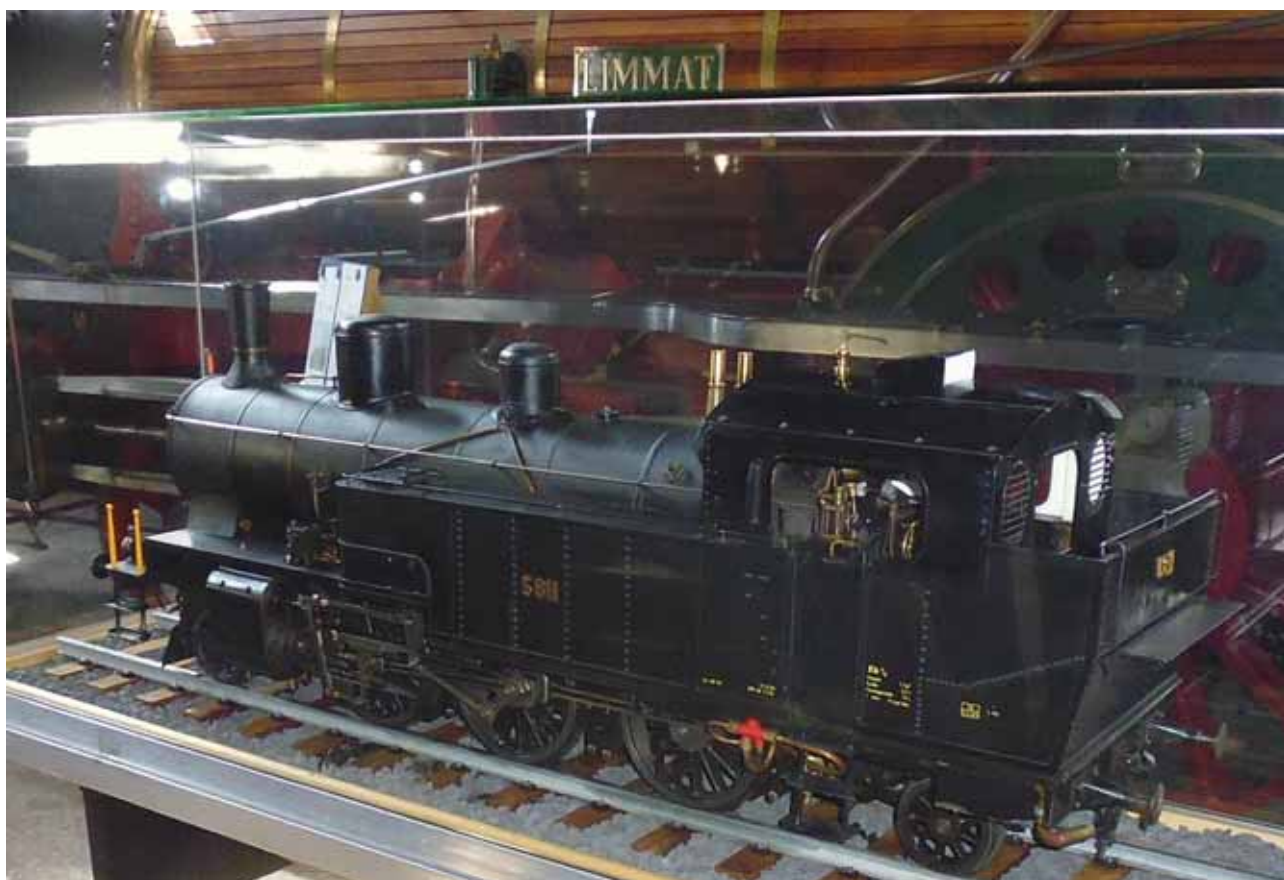
Eb 3/5 in 5", perfettamente funzionante a carbone, costruita da Zeno Biland del DMC-CH di Zurigo
