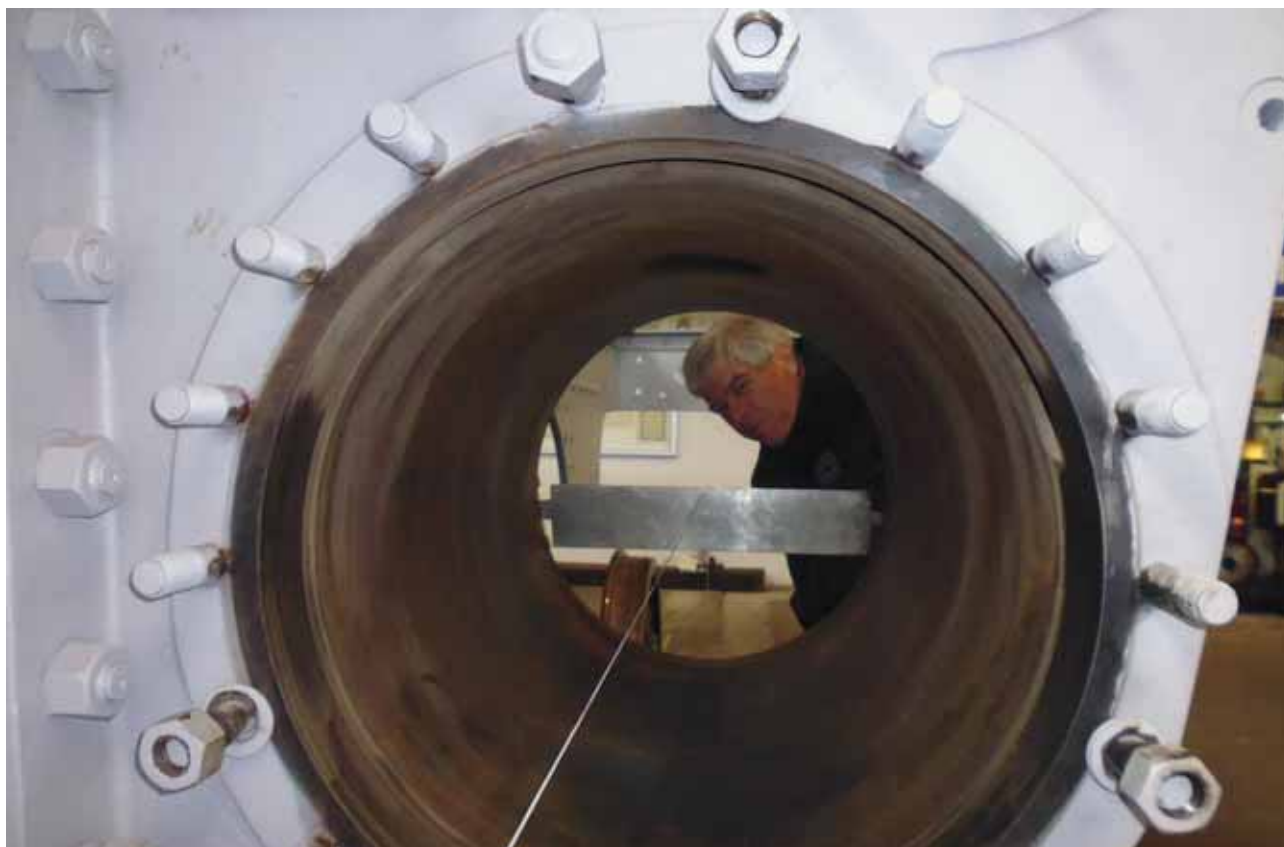
Per allineare i cilindri non si usa il laser ma semplicemente una cordina
