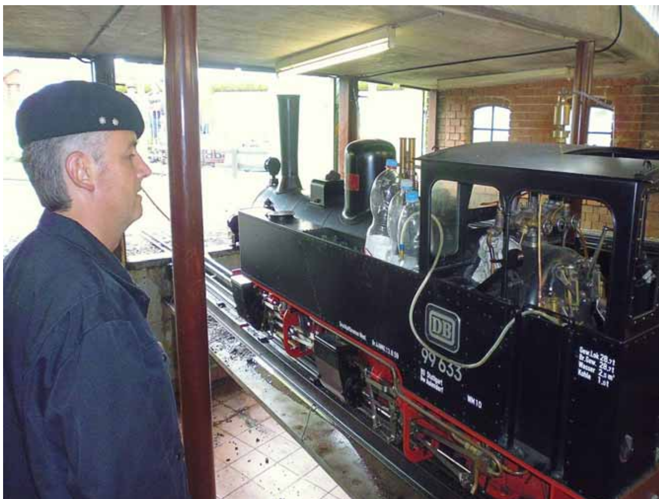
Ravelli osserva la condotta che porta il carburante dalla bottiglia PET al bruciatore
