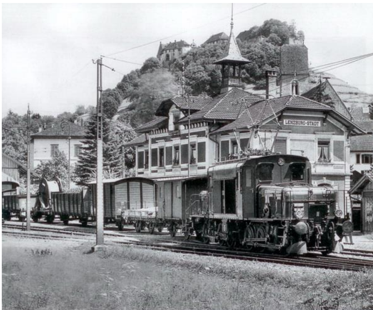
Kurz nach der Ablieferung im Jahr 1926 wurde die De 6/6 Nr. 15302 im Bahnhof Lenzburg-Stadt vor einem Güterzug der Seetalbahn für den BBC-Werkfoto- grafen in Szene gesetzt. Foto: BBC/SLG, Pfeiffer Linke Seite oben: Bei der Aufarbeitung in Balsthal wurden die Anschriften und Schilder an den Seiten und Fronten originalgetreu hergerichtet. Die Antriebsart mit den drei Treibachsen und der Vorgelegewelle entspricht genau den Rangierlokomotiven Ee 3/3 (De 6/6 Nr. 15301). Foto: P. Pfeiffer (2)
