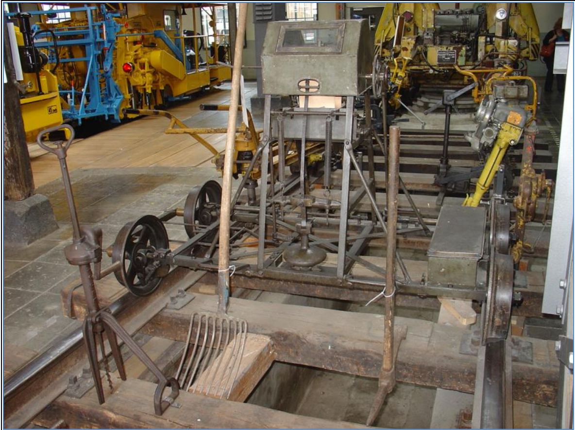
Registratore di misura della geometria dei binari e macchinari per la posa e la manutenzione dei binari
