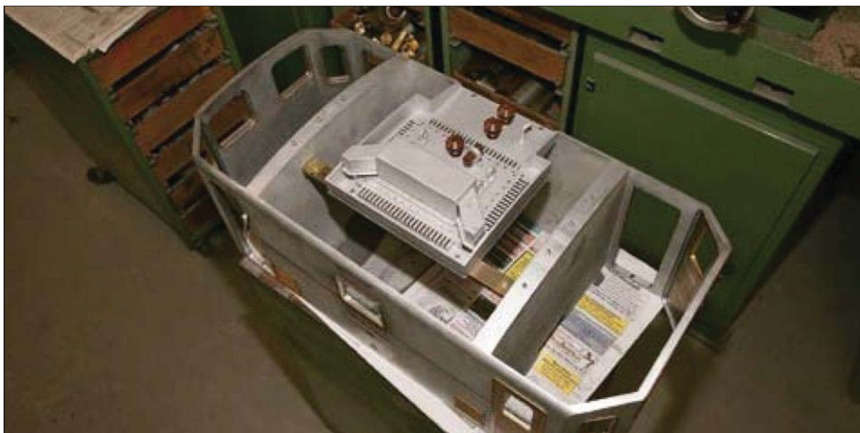
blocco centrale prodotto con elettroerosione a filo
