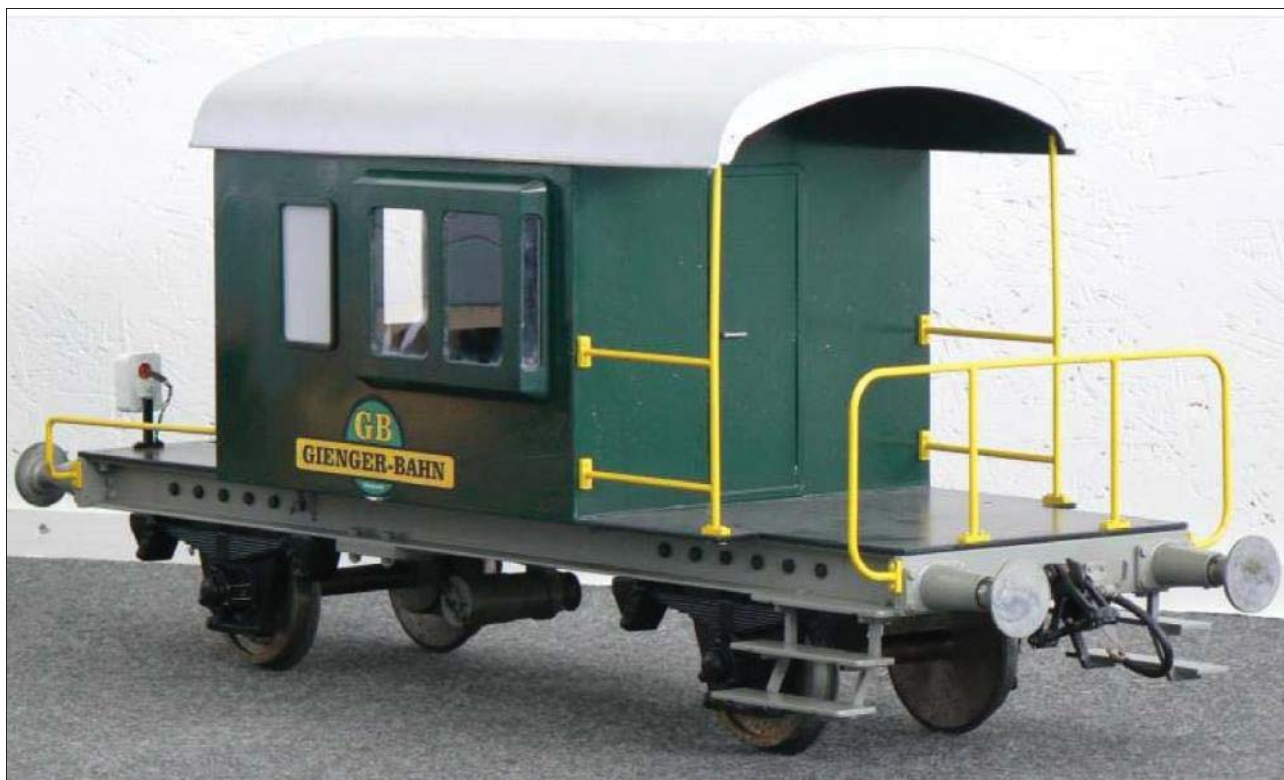
Sputnik con generatore di corrente per alimentare la lanterna rossa di coda
