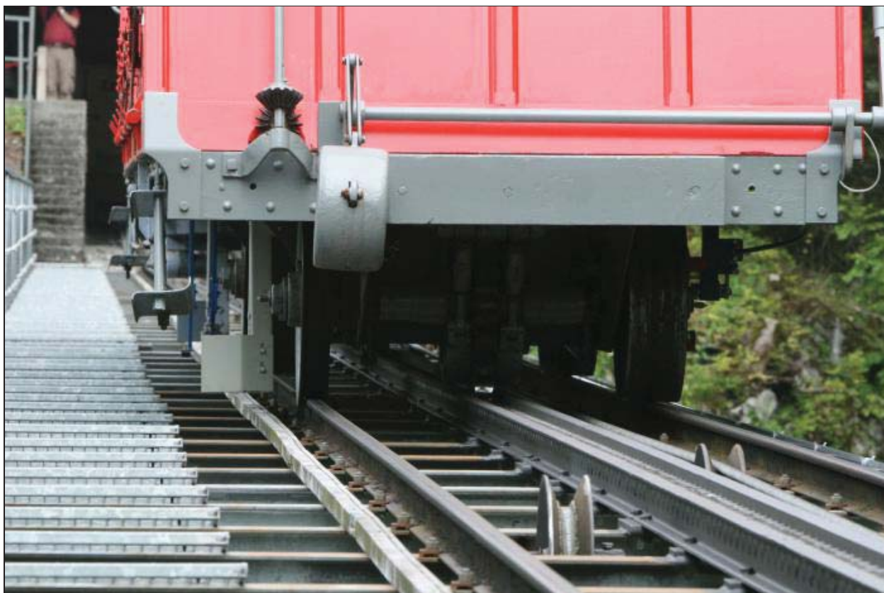
die äusseren Räder haben zwei Spurkränze; die inneren Räder sind breit ohne Spurkränze
