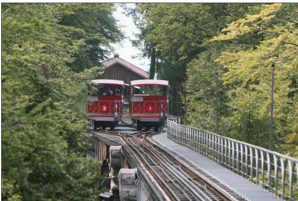
die äusseren Räder haben zwei Spurkränze; die inneren Räder sind breit ohne Spurkränze
