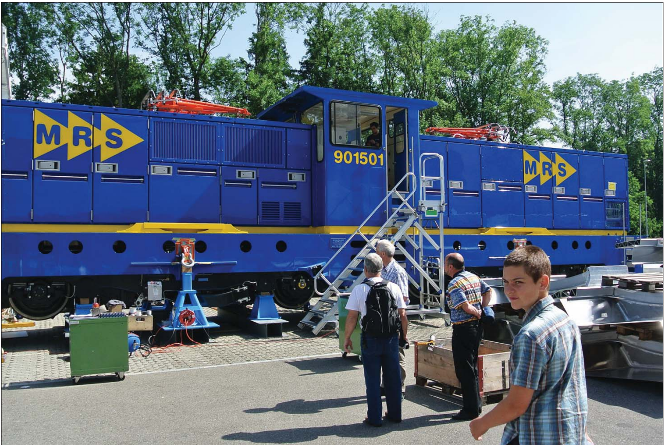
Una delle 7 He 4/4, la piú potente locomotiva a cremagliera del mondo (5000 kW), venduta alla MRS Logistica SA (Brasile)
