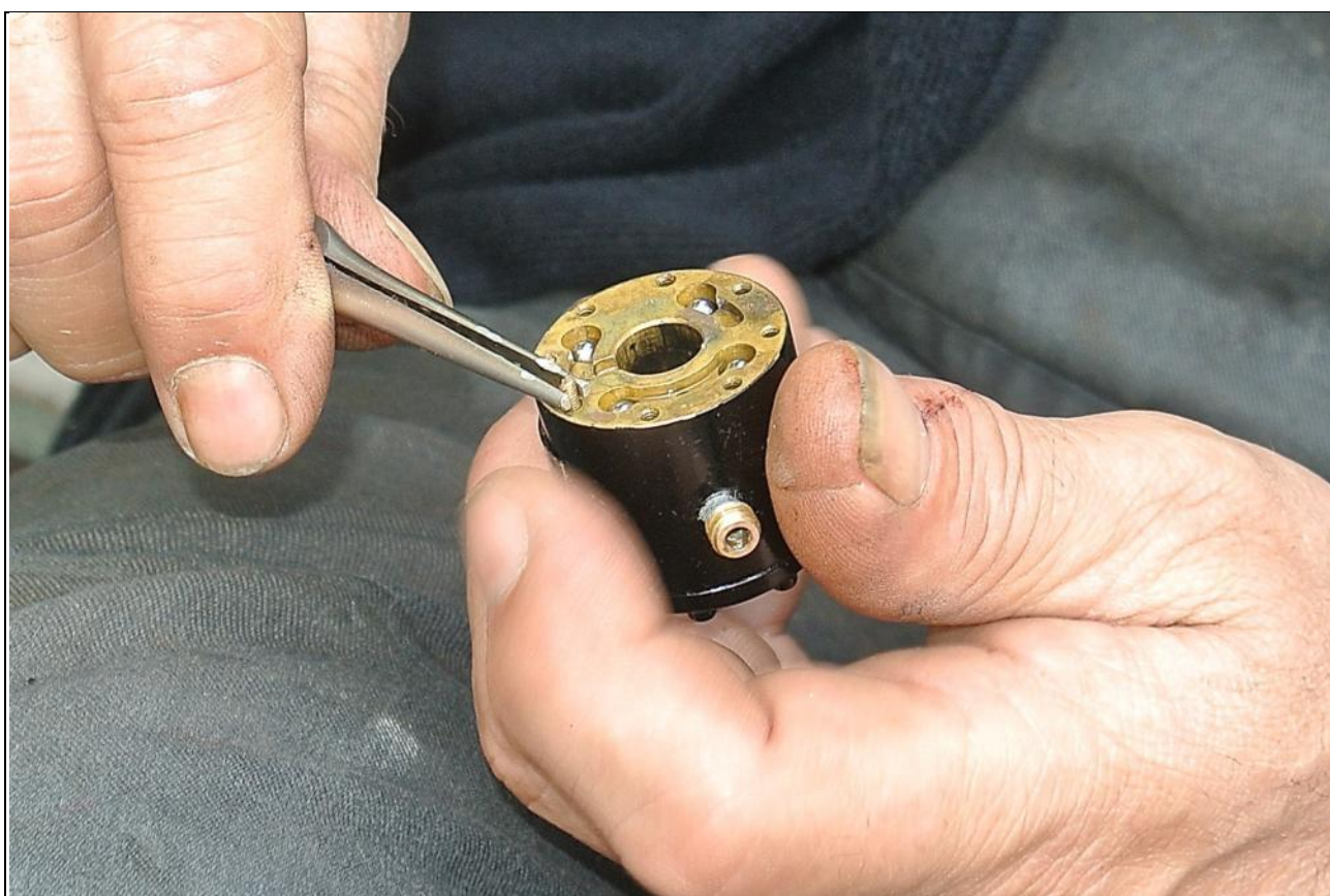
smontaggio della pompa vapore della B3/4 di Dominic (le mani sono di Zeno Biland)
