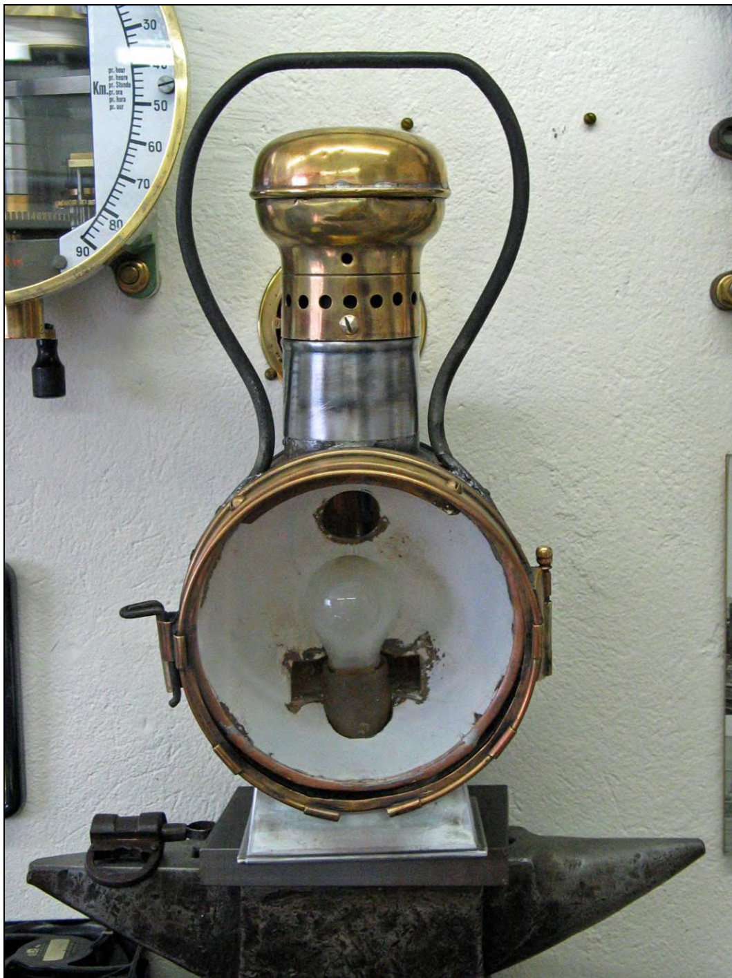
lampada saldata e assemblata, prima della verniciatura.
