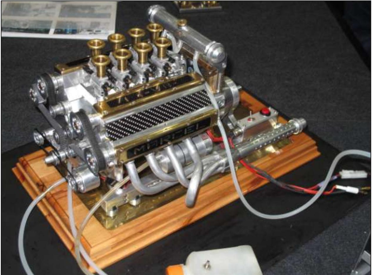
8 cilindri a V funzionante a miscela di metanolo
